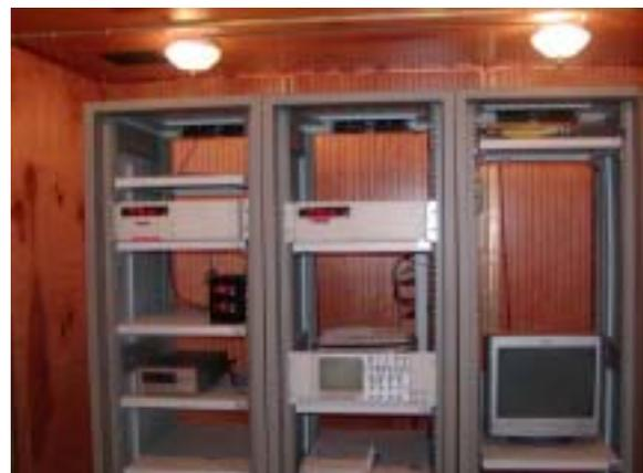
写真6 この2台のセシウム時計がタイの標準時を管理している
