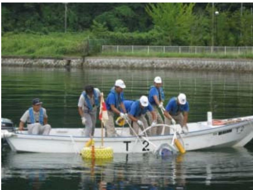
超音波流速計の投入実習
