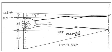
図1 量天尺による恒星高度の簡便な測定(筆者原図) (本文にもとづいて描いたもので、1寸と4寸目盛の儀器の場合)
