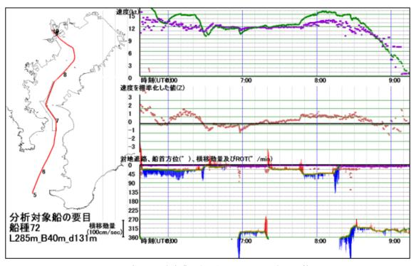
図1 湾口から東京港へ向かう大型コンテナ船の動静
