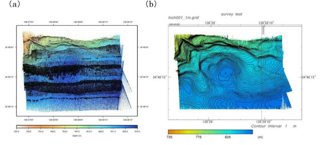
図2 船上一次処理前(a)と処理後(b)の海底地形図
